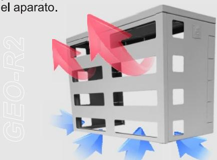
**Convección forzada:** El aire caliente del intercambio térmico es expulsado por el ventilador a través del panel frontal
